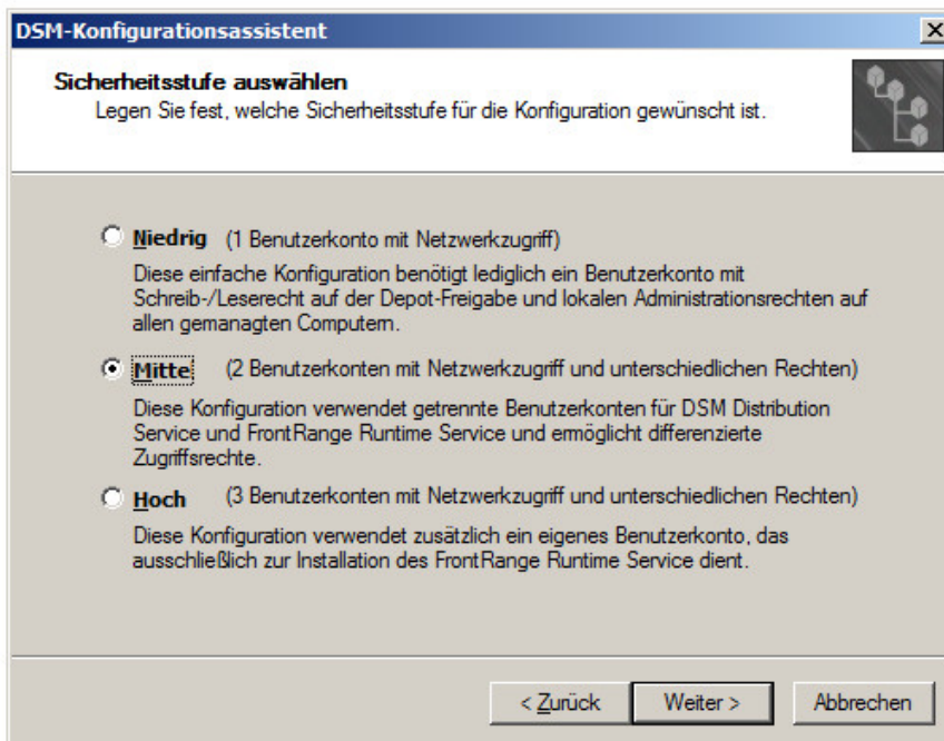
Abbildung 1: Auswahl der Sicherheitsstufe während der Softwareinstallation von FrontRange DSM, die die Anzahl benötigter Benutzerkonten beeinflusst
